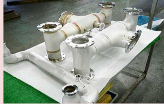
ステンレス真空配管
